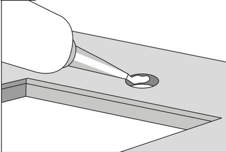
14 a-b) Hahnlochbohrungen mit Naturstein-Silikon wasserdicht versiegeln.
