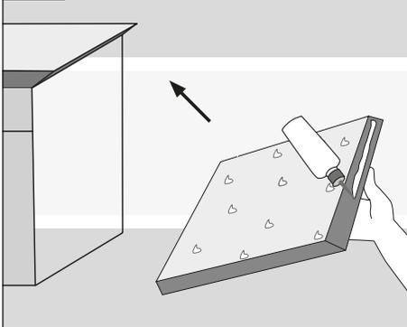
22 c-d) Ajouter du silicone sur les faces arrière des plateaux et coller sur le côté du meuble bas.
